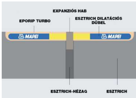
Az esztrich dilatációs dübel utólagos beszerelésének vázlatos ábrázolása
